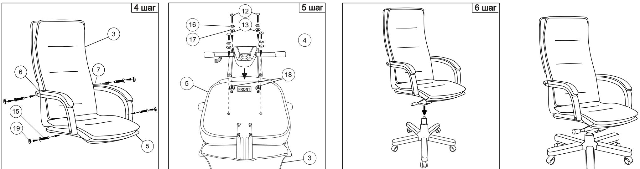
**Примечания:** Шаг 2. Снять защитный колпачок с газлифта, в случае его наличия. Шаг 3 - 4. Вставить и закрутить винты поочерёдно, не затягивая их до конца. После выполнения шага 4 закрутить все винты до полной фиксации.
